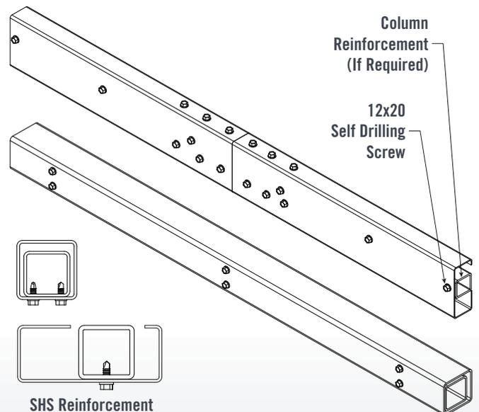
**ROLLER DOOR HEADER BEAM REINFORCEMENT**
