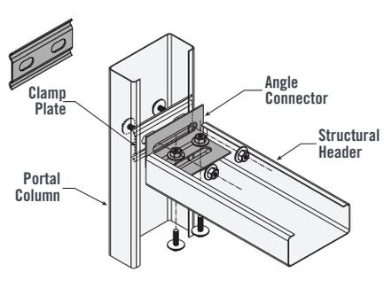
**GLASS SLIDING DOOR COLUMN TO HEADER BEAM**
