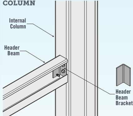
**HEADER BEAM CONNECTOR SLEEVE**
