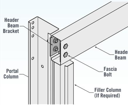
**GUTTER SIDE HEADER BEAM JOINER**
